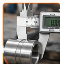
EXTERIOR Diámetros externos
